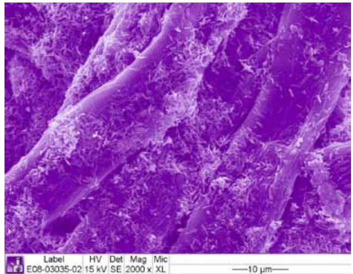
Elektronenmikroskopische Aufnahme eines pigmentierten Papiers
